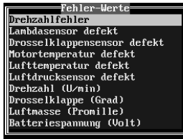
Auswahl des Defektes, auf den ein Sensor überwacht werden soll
